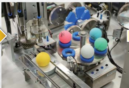
ゼネバを使用した回転テーブルによる分割 インデックス駆動
