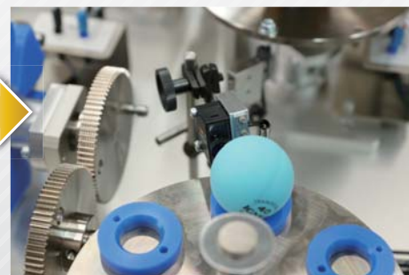
色センサを使用した外観検査
