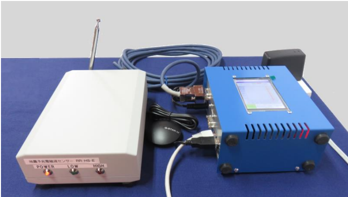
逆ラジオ=電磁波ノイズセンサ(左) コントローラ(右)
